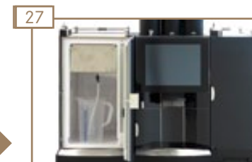
De slangen worden geleegd in de reinigingscontainer.
